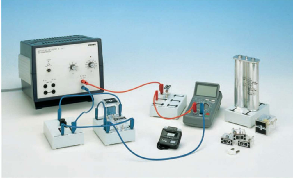
Şekil 2 Sıđaç boşalması deney düzeneđinin kurulması
