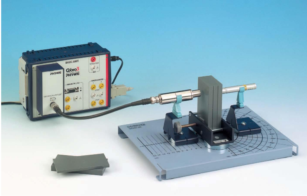
Şekil 4.6. Farklı materyallerin yarı-değer kalınlık ölçümü için deney düzeneği
