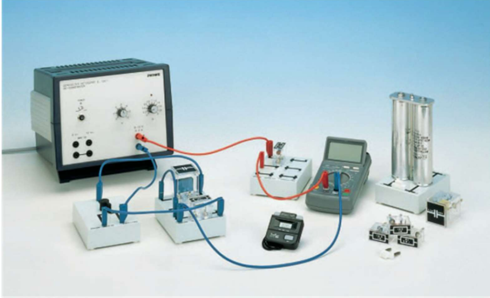
Şekil 7-2 Sıđaç boşalması deney düzeneđinin kurulması
