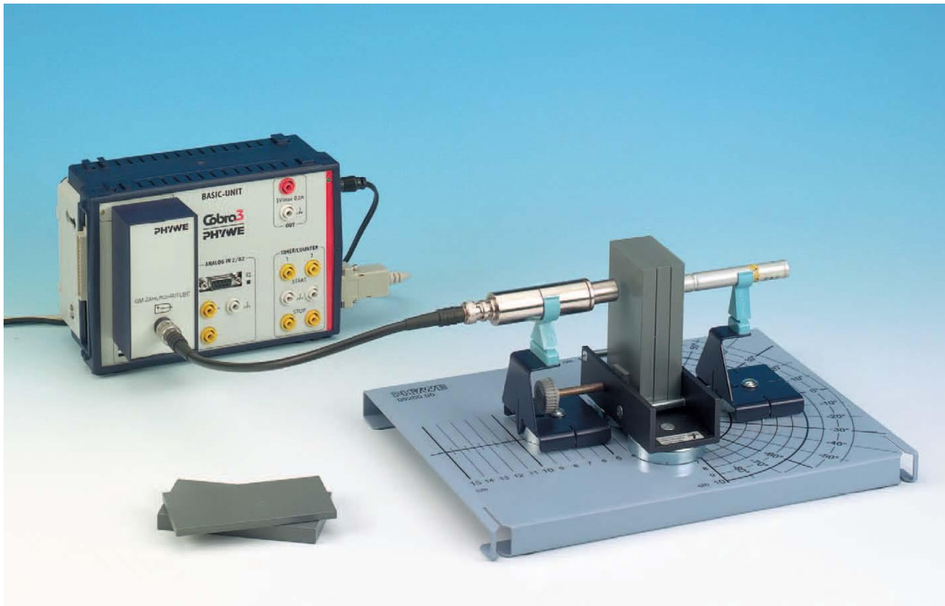
Şekil 6. Farklı materyallerin yarı-değer kalınlık ölçümü için deney düzeneği
