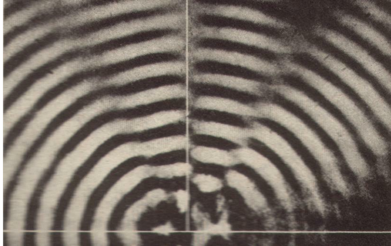
Şekil 9. Aralarında faz farkı olan iki kaynaktan çıkan dalgaların girişimi
