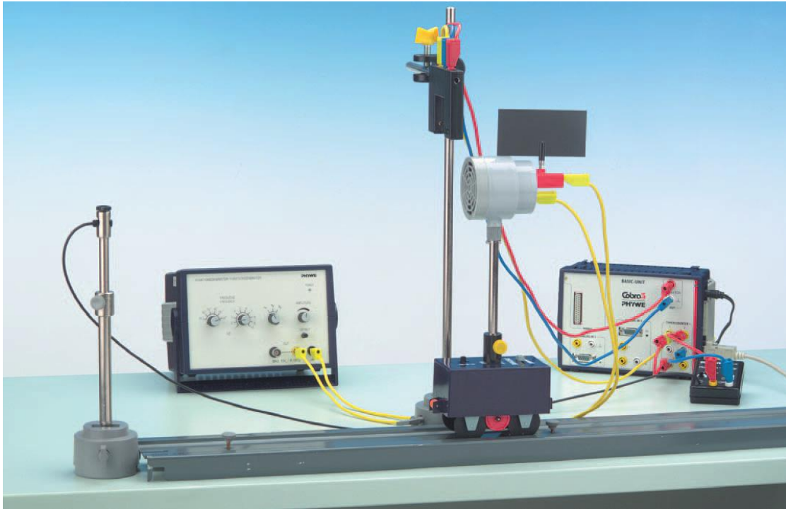
Şekil 3. Ses kaynağı hareketli, gözlemci hareketsiz olduğundaki deney düzeneği
