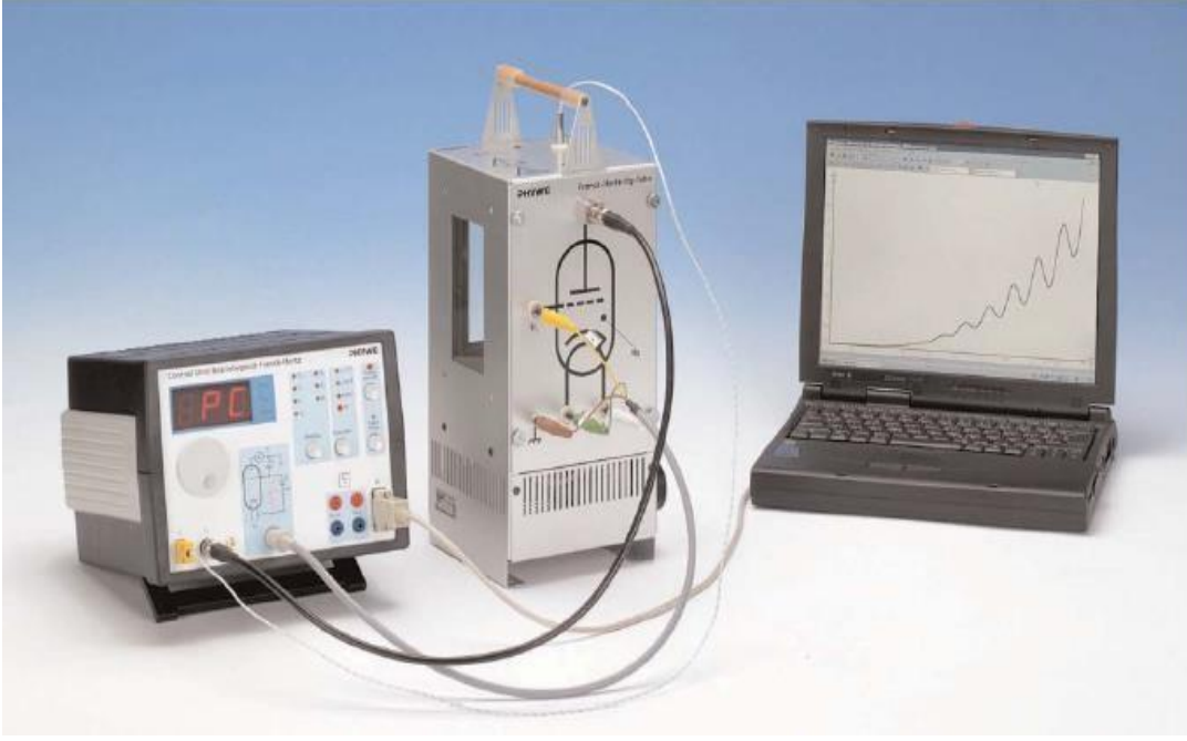
Şekil 6.3. Franck-Hertz deney düzeneği
