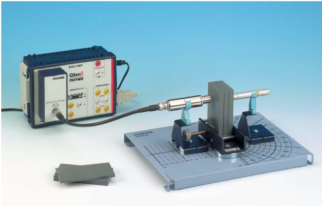
Şekil 9.6. Farklı materyallerin yarı-değer kalınlık ölçümü için deney düzeneği
