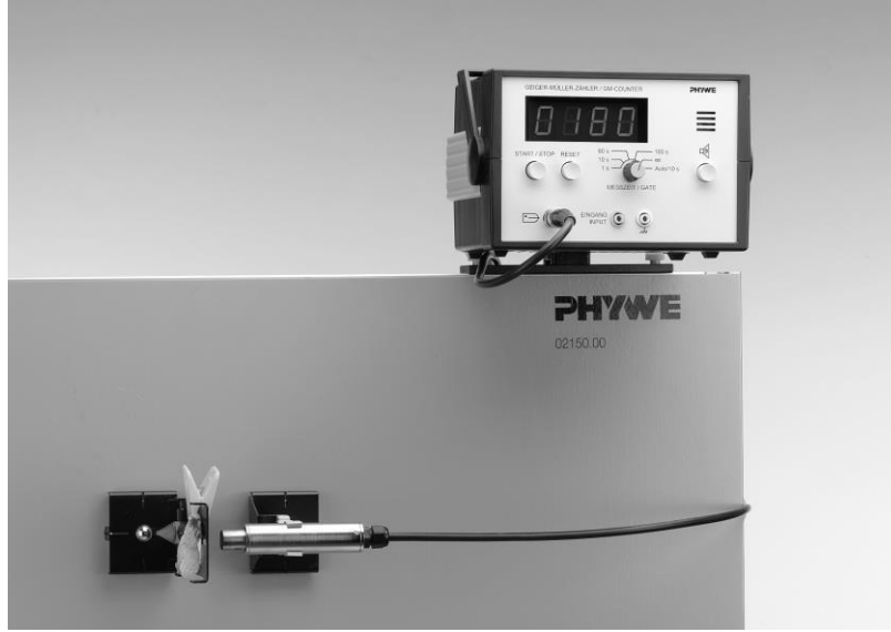
Şekil 7.2: Geiger-Müller Sayacı Deney Düzeneği
