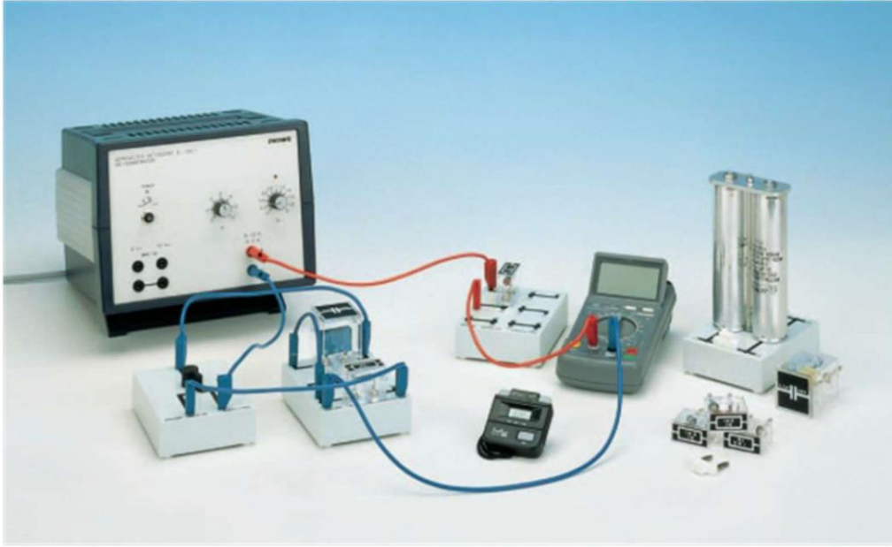
Şekil 7-2 Sığaç boşalması deney düzeneğinin kurulması
